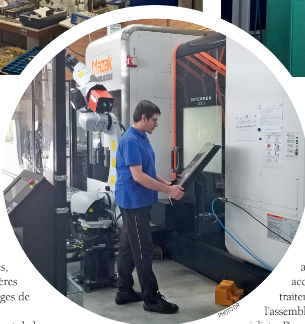
Le centre d'usinage 5 axes et son robot de chargement et déchargement.
