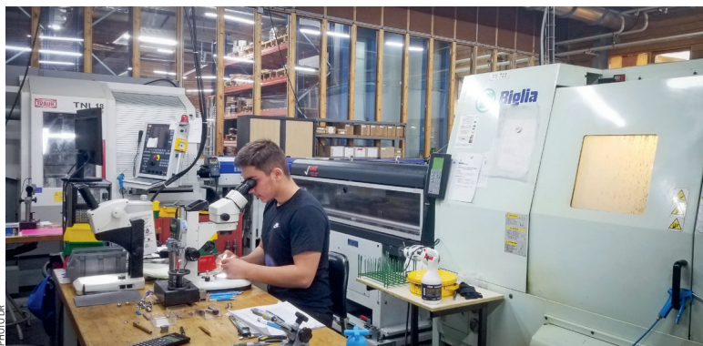
Vérification au microscope d'une pièce sortie de la machine-outil.
